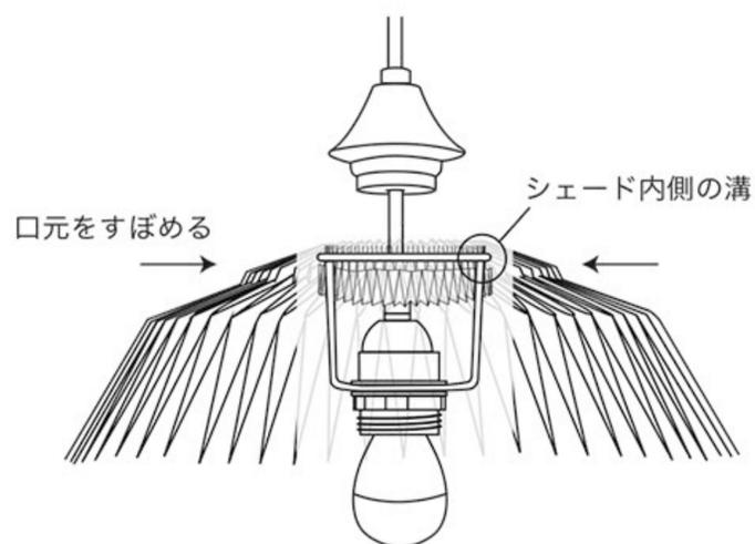
③シェード上部を閉じ、取り付けられた電球（ランプソケット側）のフレームをシェード内側の溝にはめ込みます。
