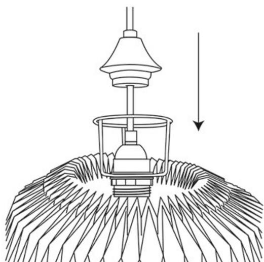
②シェード上部を広げ、取り付けられた電球（ランプソケット側）をシェード上部から下部へ通します。
