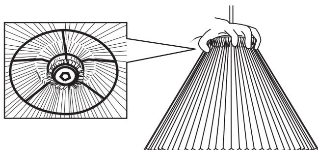
④シェード上面を手のひらですぼめるように持ち、シェード内側の折り返し部分をフレームの一番上のリングに引っ掛けるようにかぶせます。
