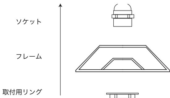
②灯具のソケットに付属している取付用リングを回して外し、左図の順番でフレームをソケットに取り付けます。
