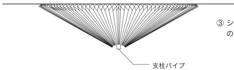
③ シェードを灯具に被せます。その際にシェード先端部の穴から支柱パイプが見える状態にします。
