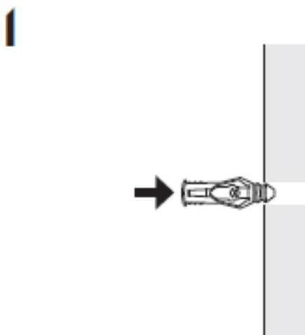
下穴を開けたボードにアンカーを差し込みます。
